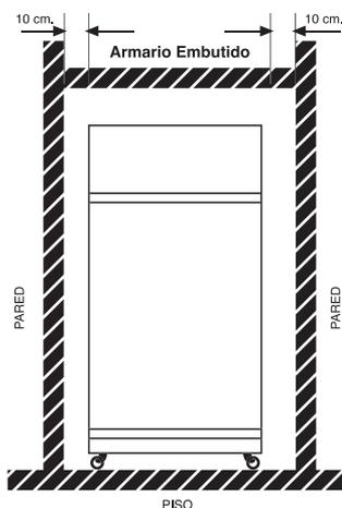
Mantener ventilaciones en la envolvente o estructura del equipo libre de obstrucción.
